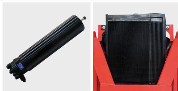
Sistema de travagem totalmente assistido por energia hidráulica com forte capacidade de travagem. É utilizado o acumulador de bexiga de alta capacidade e excelente desempenho, com alta confiabilidade de frenagem de emergência.
