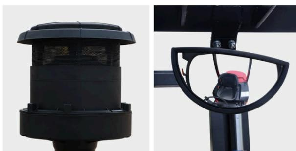
O sistema de admissão de ar do motor possui pré-filtro externo para melhorar a limpeza da admissão de ar, aumentando assim a vida útil do motor.
